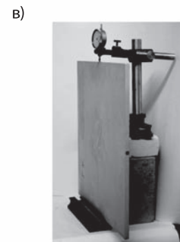
Рисунок 1.2. Приборы для замеров линейных размеров образцов длиной 160 мм (а); 450 мм (б) и (в)
