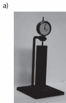
Рисунок 1.2. Приборы для замеров линейных размеров образцов длиной 160 мм (а); 450 мм (б) и (в)
