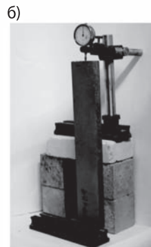
Рисунок 1.2. Приборы для замеров линейных размеров образцов длиной 160 мм (а); 450 мм (б) и (в)
